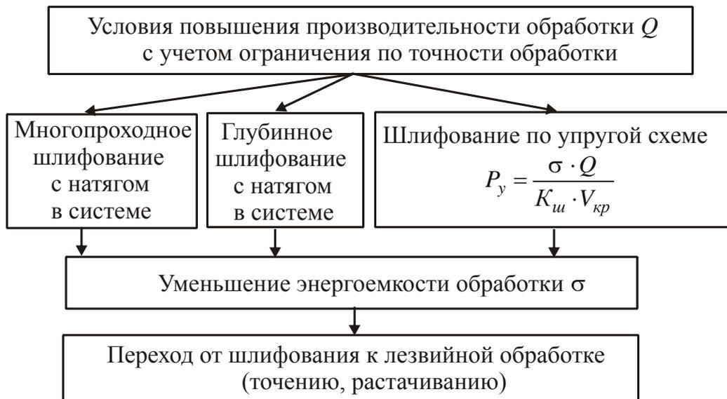
Рис. 3. Структурная схема условий повышения производительности обработки
