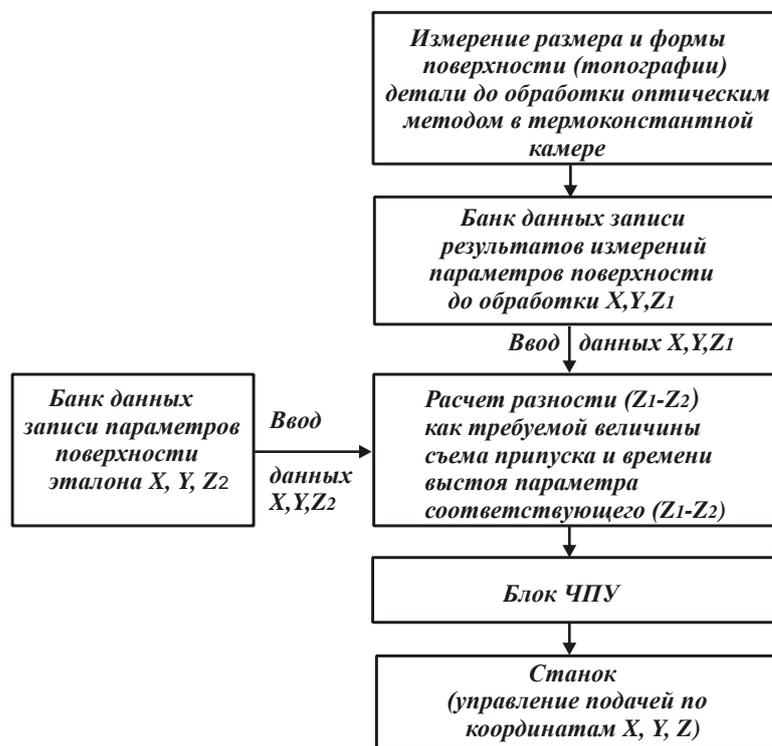
Рисунок 3 – Схема управления процессом формообразования поверхностных слоев деталей
