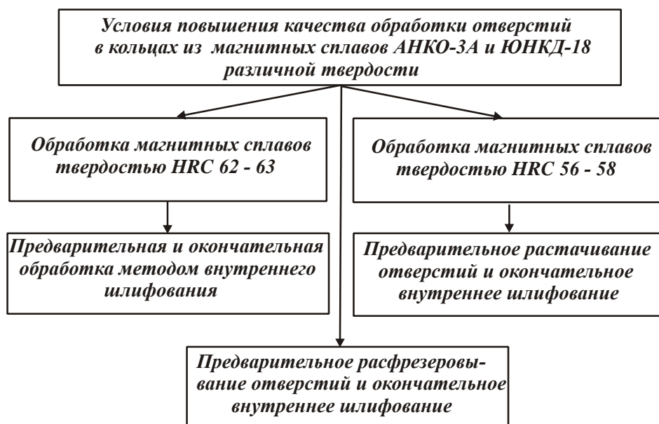
Рис. 6. Структурная схема условий повышения качества обработки отверстий в кольцах из магнитных сплавов.
