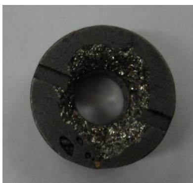
Рис. 3. Образующиеся микросколы на торцевой поверхности кольца
