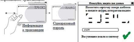
3. Пользователь накладывает карту с ключом и зрительно проверяет совпадения информации о транзакции, после этого он вводит одноразовый пароль, чтобы провести аутентификацию транзакции
