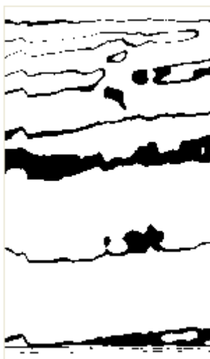
Рис. 4 Пример сегментации изображения при двухпороговом квантовании
