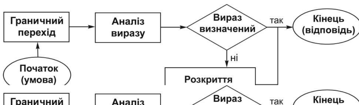
Рис. 7.2.1. Структурна схема алгоритму відшукування границі ч/п
