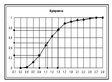
Рис. Л5.1. **Графический способ определения квартилей**
