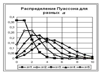
Рис. 4.8. **Вид распределения Пуассона** в зависимости от параметра *а*
