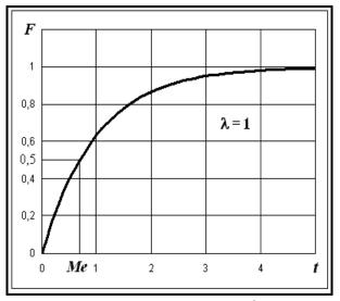
Рис. 6.6. Функции распределения показательного закона для  $\lambda = 1$
