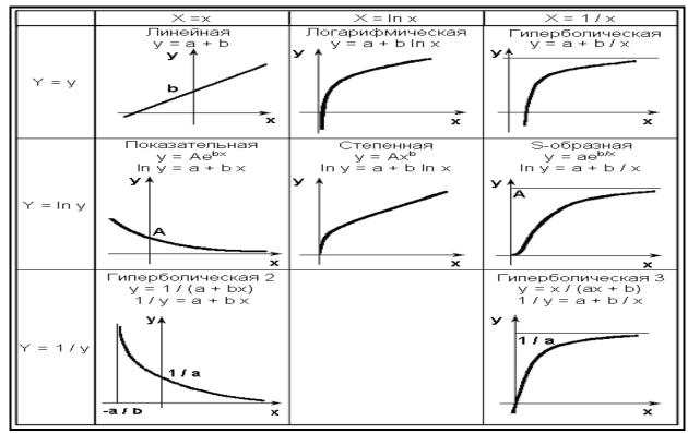
Рис. 14.7. Двухпараметрические зависимости Y = a + bX
