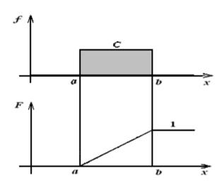
Рис. 6.3. Равномерный закон
