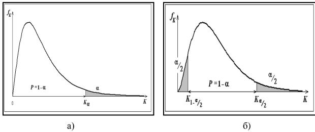
Рис. 10.3. **Критическая зона** для одностороннего (*a*) и двустороннего (*б*) критериев
