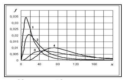
Рис. 7.5. Графики дифференциальной функции логнормального распределения  $1-(\mu_0=3; \sigma_0=0.8); 2-(\mu_0=3.5; \sigma_0=0.8); 3-(\mu_0=4.5; \sigma_0=0.8); 4-(\mu_0=4.5; \sigma_0=0.5).$
