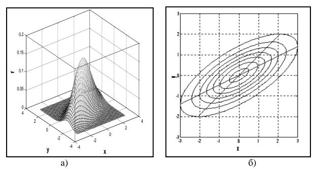
Рис. 8.4. Двумерный график плотности вероятности нормального закона (a) с параметрами ( $m_x = 0$ ;  $m_y = 0$ ;  $\sigma_x = 1,5$ ;  $\sigma_y = 1$ ;  $\rho_{xy} = 0,7$ ) и семейство линий уровня f = Const (б)
