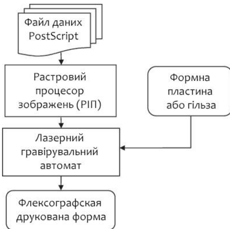
Рис. 13. Схема технологічного виготовлення флексографічних друкарських форм за технологією прямого лазерного гравірування
