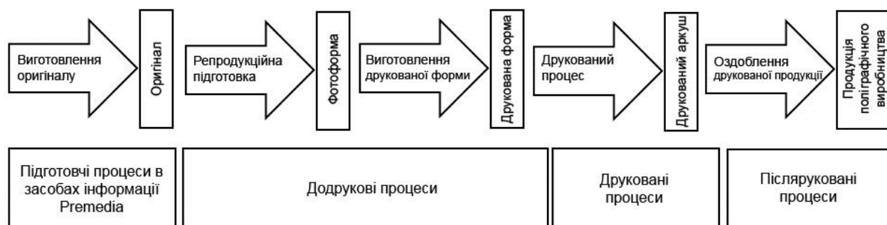
Рис. 1. Виготовлення фотоформ або друкарських форм у загальному технологічному ланцюжку випуску друкарської продукції
