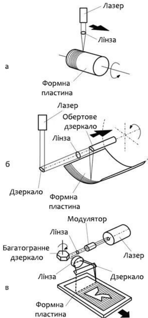
Рис. 9. Способи експонування формних пластин: а – на зовнішній поверхні барабана; б – на внутрішній поверхні барабана; в – на площині
