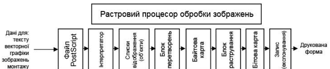
Рис. 4. Структура даних на додрукарській стадії, яку може виконувати RIP
