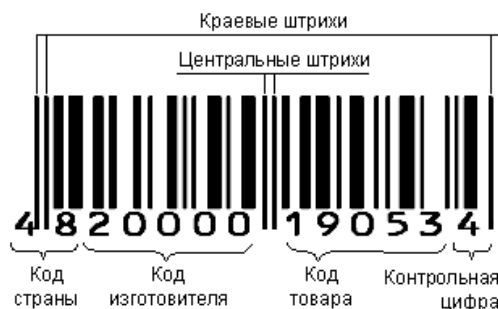
Рис. 2. Структура штрихового кода EAN-13
