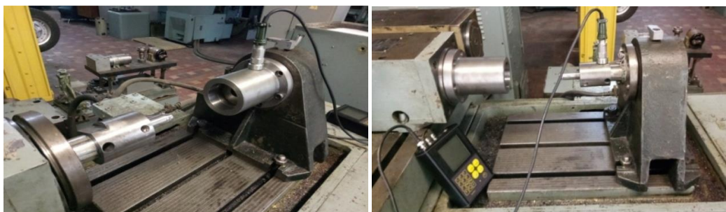
Рисунок 1 – Загальні види стендів для дослідження коливань обертових (а) і необертових (б) борштанг
