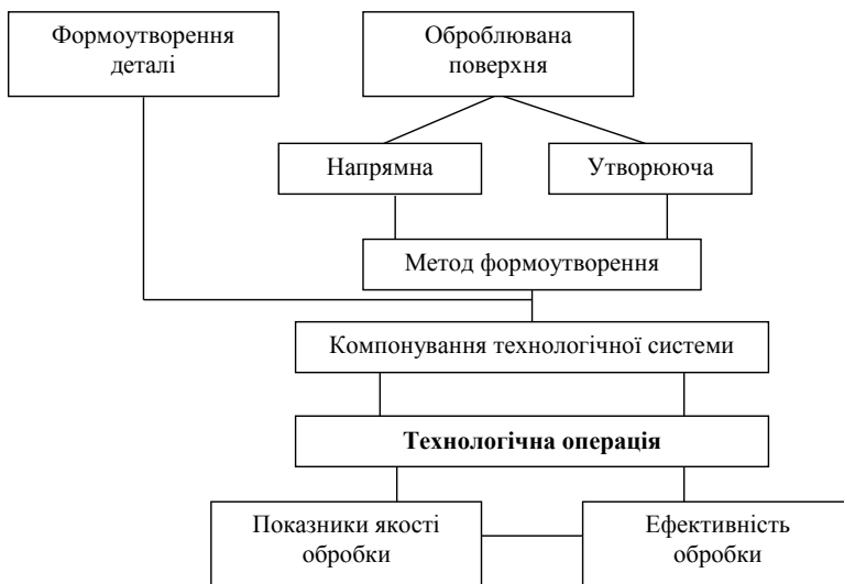
Рисунок 1.1 – Схема зв'язку чинників формоутворення і показників якості та ефективності обробки деталей під час формування технологічної операції
