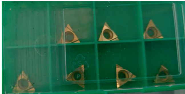
Рис. 4.6. Змінні багатогранні пластини TPGX090202L DC100T
