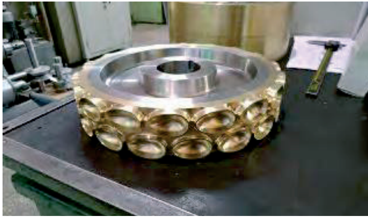
Рис. 4.12. Деталь – кільце вирубне ( матеріал – латунь ЛС59). Режим різання: n = 11\ 000 об./хв., S = 600 мм/хв. Інструмент – фреза твердосплавна DHF ВТВ0404. Застосовуване обладнання – FINETECH SMW1670 (Тайвань)
