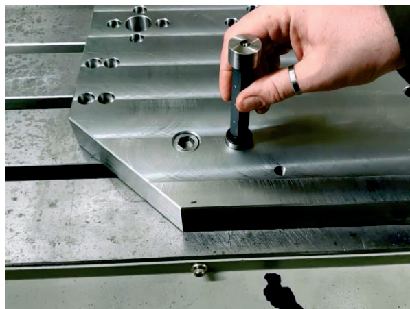
Рис. 4.7. Контроль виконання обробки поверхні із застосуванням еталону (калібр-пробка, непрохідний)
