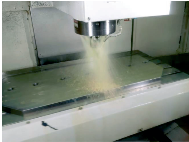
Рис. 4.5. Процес високоточного високошвидкісного розточування отвору
