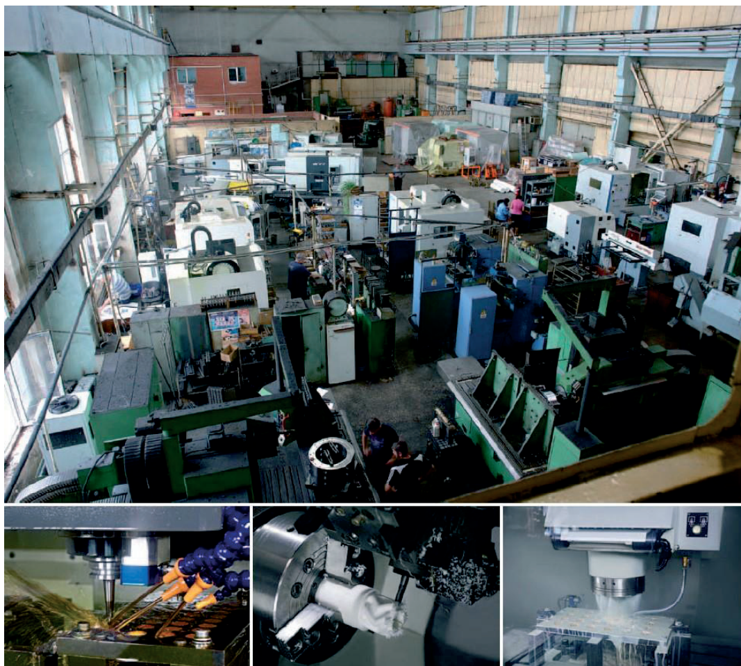
Рис. 4.4. Виробнича дільниця для виготовлення складнопрофільної формуючої оснастки для харчової промисловості, яку оснащено сучасними високоточними металооброблювальними центрами і верстатами із ЧПУ
