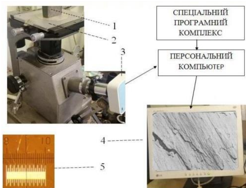
Рисунок 1 – Комп'ютерний мікроскоп, налагоджений для проведення фактографічних досліджень
