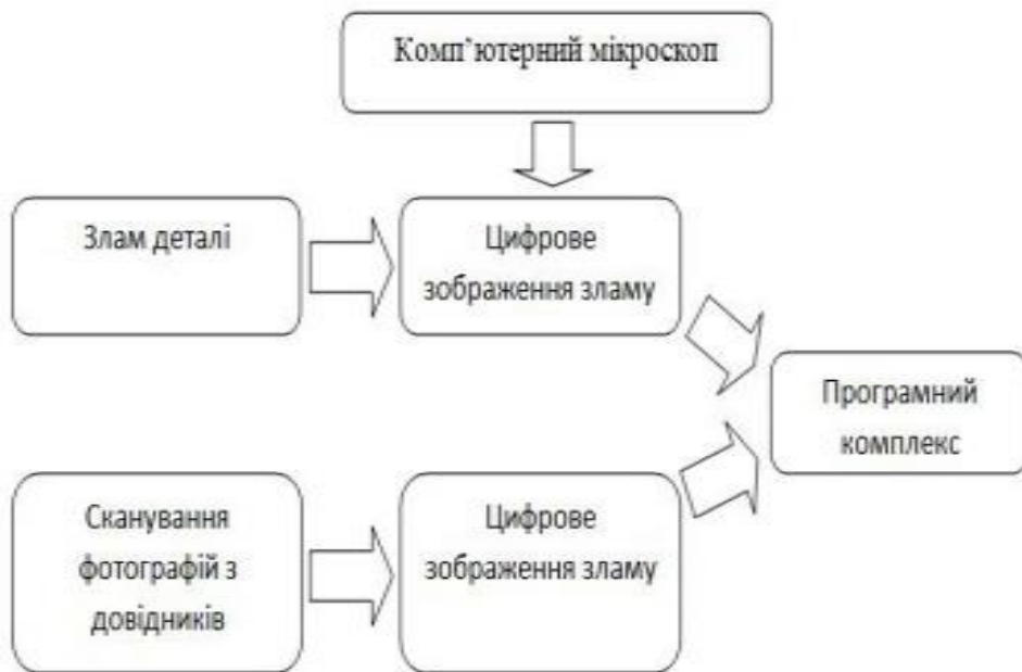
Рисунок 2 – Принципова схема отримання цифрових зображень зламів деталей для їх подальшого аналізу
