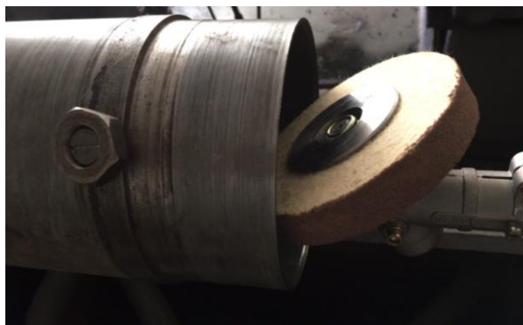
Рисунок 1 – Внешний вид оправки с углом наклона оси абразивного круга к оси обрабатываемого цилиндра 60^\circ
