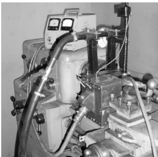
Рисунок 5 – Дозирующее устройство с импульсным полюсным наконечником для подачи ферропорошка
