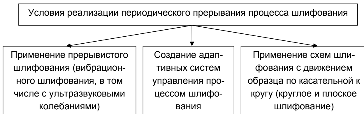
Рис. 6.16. Структурная схема условий реализации периодического прерывания процесса шлифования
