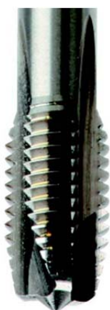
Рис. 1.7. Метчик с прямыми канавками для нарезания резьбы в сквозном отверстии
