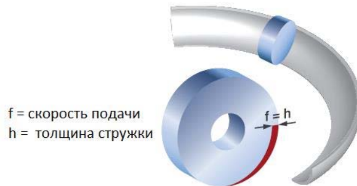
Рис. 3.58. На половине диаметра круглой пластины скорость подачи на пластине равна толщине стружки
