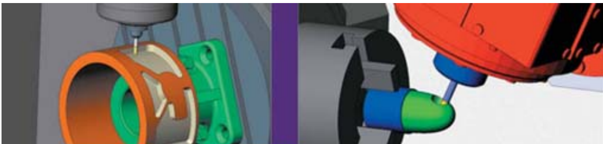
Рис. 3.20. Моделирование обработки в ESPRIT посредством технологии ProfitMilling для 3-х, 4-х и 5-осевой обработки
