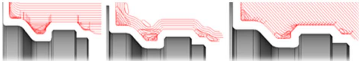
Рис. 3.27. Траектории обработки: параллельно оси, со смещением и под углом
