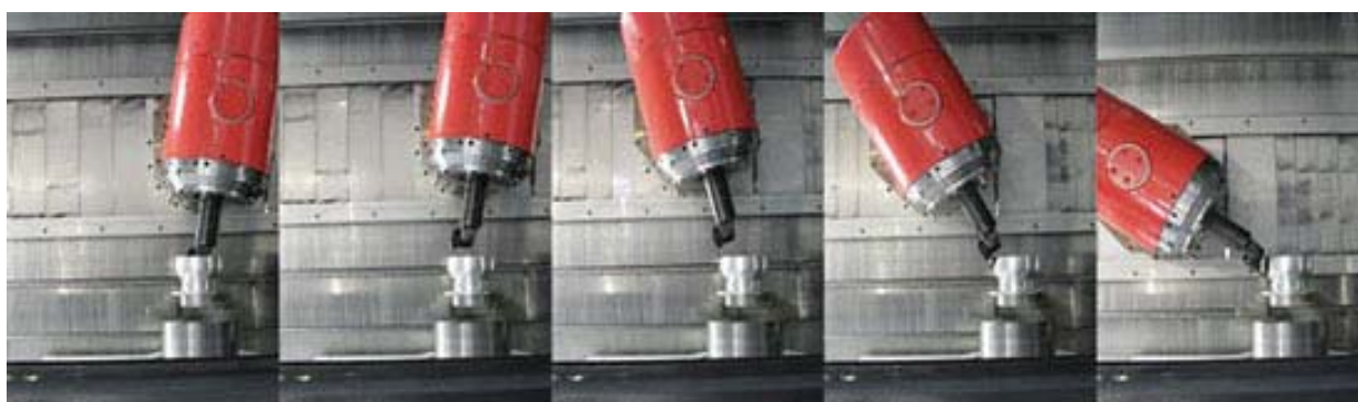
Рис. 3.93. Непрерывная финишная обработка с использованием оси В без смены инструмента
