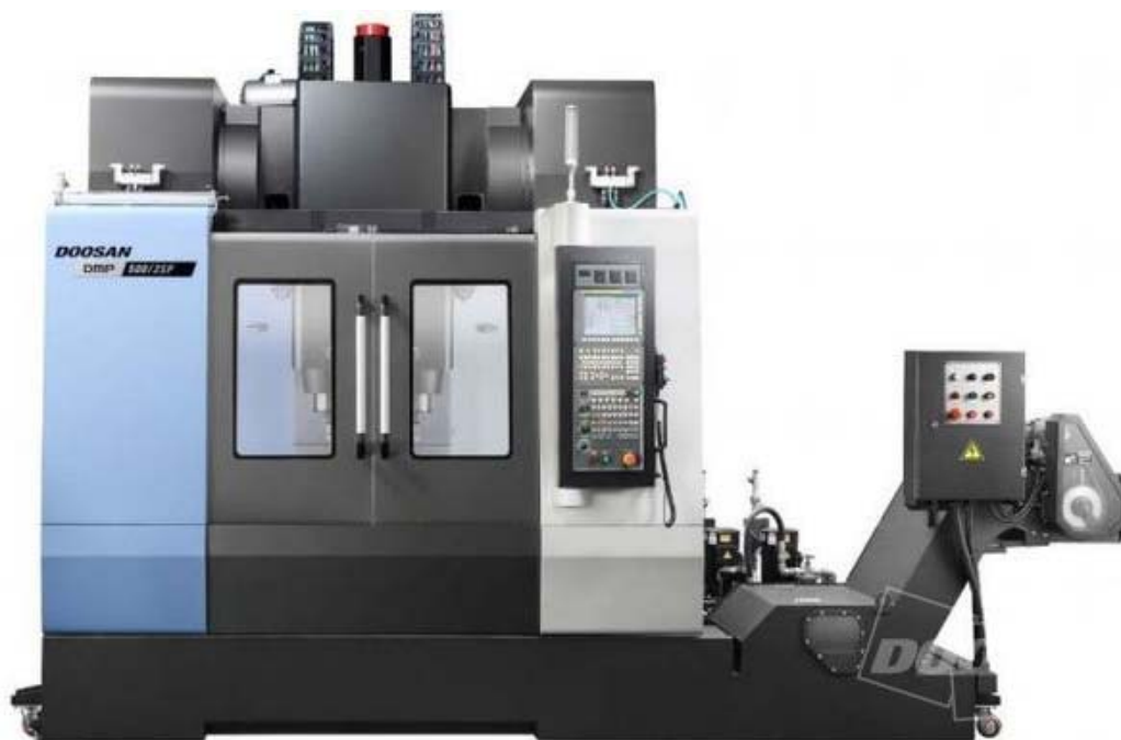
Рис. 2.20. Высокопроизводительный вертикально-обрабатывающий центр DMP 500 / 2SP с двумя высокооборотными шпинделями
