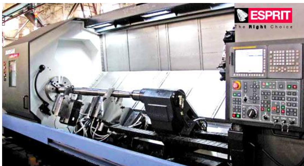
Рис. 3.7. Обработка детали "Вал" на станке DOOSAN 700XLY с применением ПО ESPRIT
