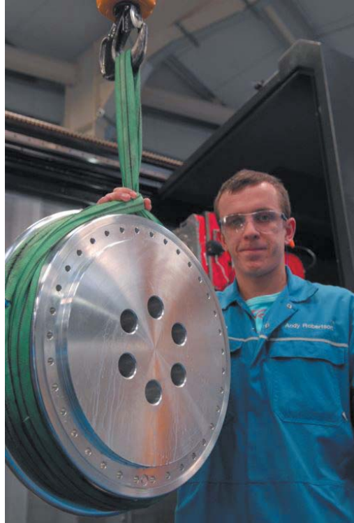
Рис. 3.36. Цельные алюминиевые колеса весом 90 кг и диаметром 900 мм
