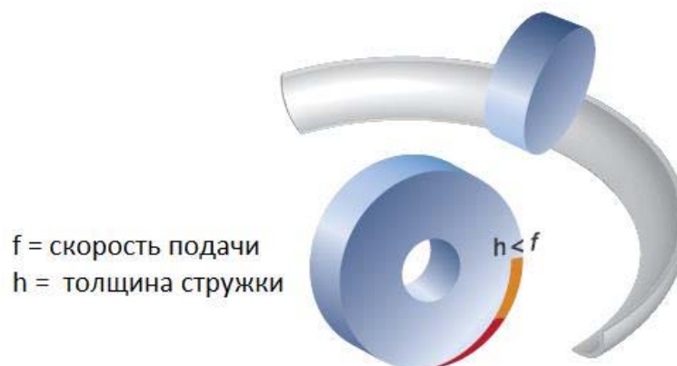
Рис. 3.59. Глубина резания уменьшается, а скорость подачи увеличивается
