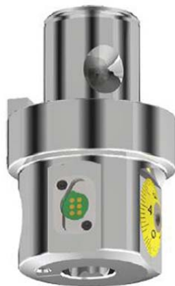
Рис. 1.19. Цифровые чистовые расточные головки диаметром 0,3 ... 88,1 мм: диаметральная регулировка 0,001 мм, с внутренним подводом СОЖ, расточные оправки проходят через головку
