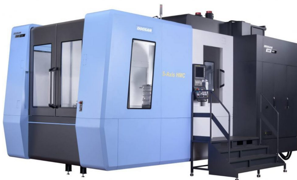
Рис. 2.32. 5-осевой горизонтальный обрабатывающий центр с двойным поддоном и шпиндельной головкой поворотного типа
