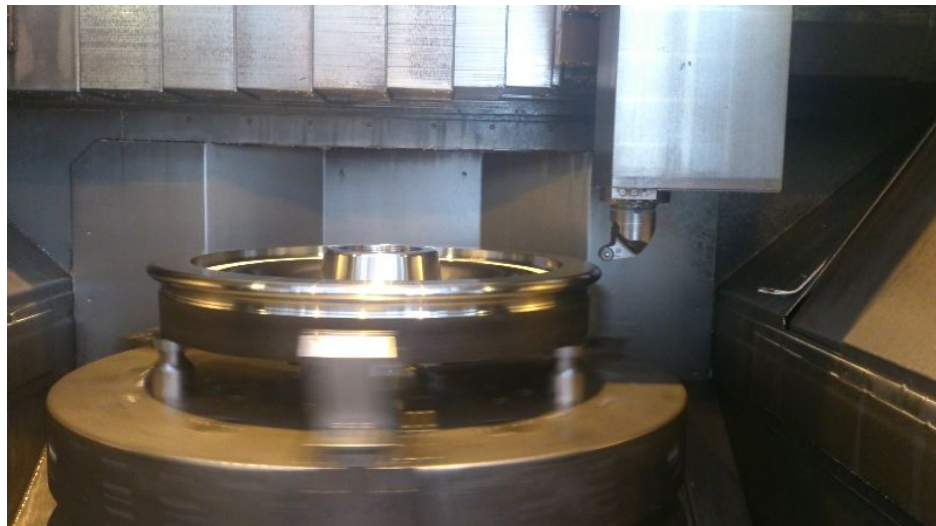
Рис. 3.6. Симуляция обработки в САПР ESPRIT и процесс резания на станке
