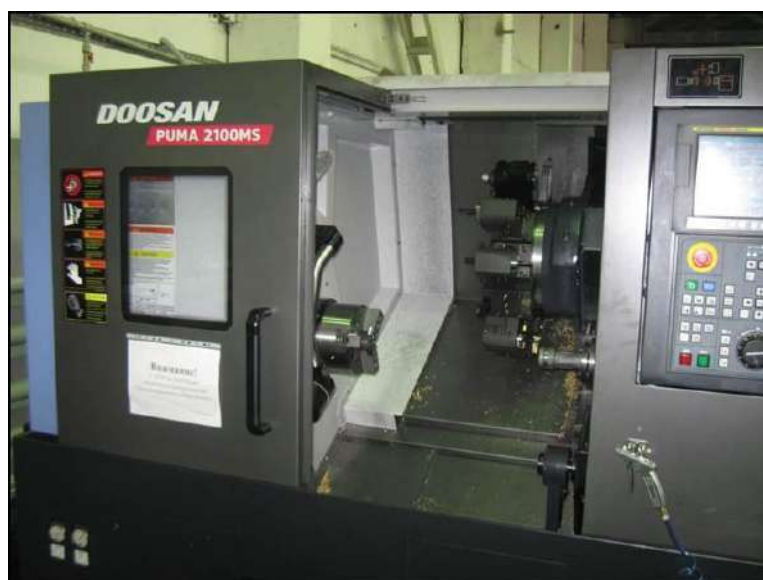
Рис. 10.16. Високопродуктивний двошпиндельний токарний обробний центр PUMA 2100MS із приводним фрезерним інструментом і контршпинделем (DOOSAN)
