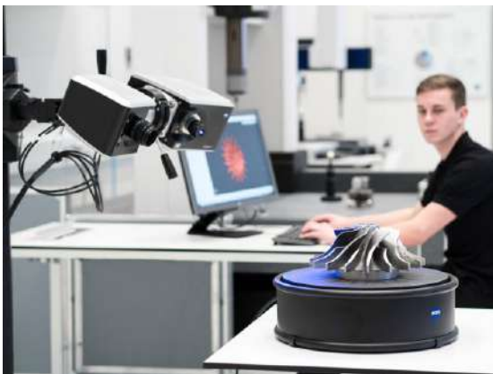
Рис. 1.5. Способи матеріалізації 3D CAD-моделей: 3D-сканер (а); 3D-принтер (б)
