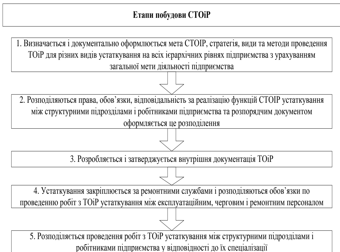
Рис. 1 Етапи побудови системи технічного обслуговування та ремонту устаткування Для встановлення рівня якості системи ТОіР устаткування, пропонується враховувати наступні фактори:
