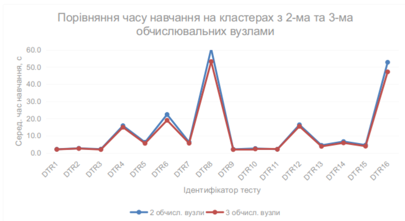
Рисунок 57 – Графік для порівняння часу навчання на гомогенних кластерах з 2-ма та 3-ма обчислювальними вузлами
