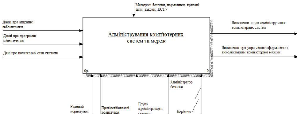
Рисунок 1. Контекстна діаграма процесу адміністрування комп'ютерних систем і мереж (TO-BE)
