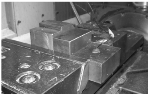
Рисунок 1 – Розташування вібродатчиків на призматичному зразку (ліворуч) і налагоджування на виконання робочого ходу фрезерування (праворуч) на верстаті мод. 500V/5
