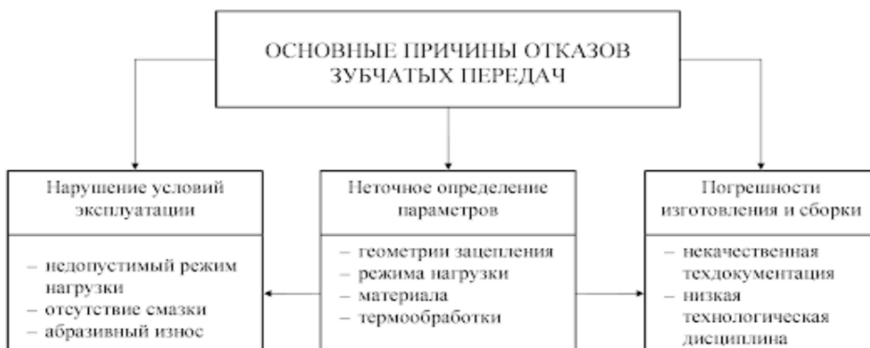
Рисунок 1 – Причины отказов зубчатых передач
