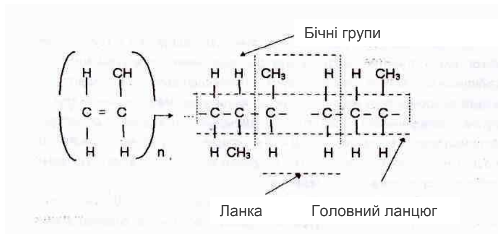
Рис. 9. Схема будови лінійної макромолекули поліпропілену
