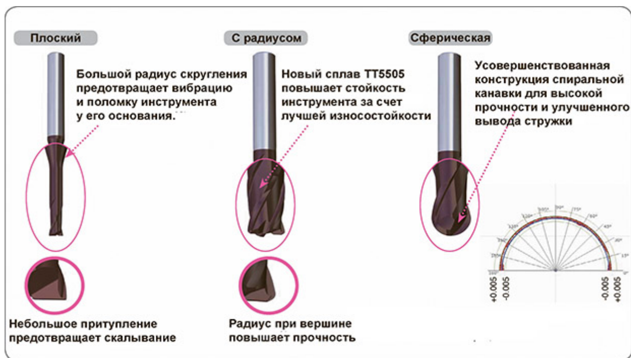
Рис. 3.13. Основные типы концевых фрез серии HARDMILL
