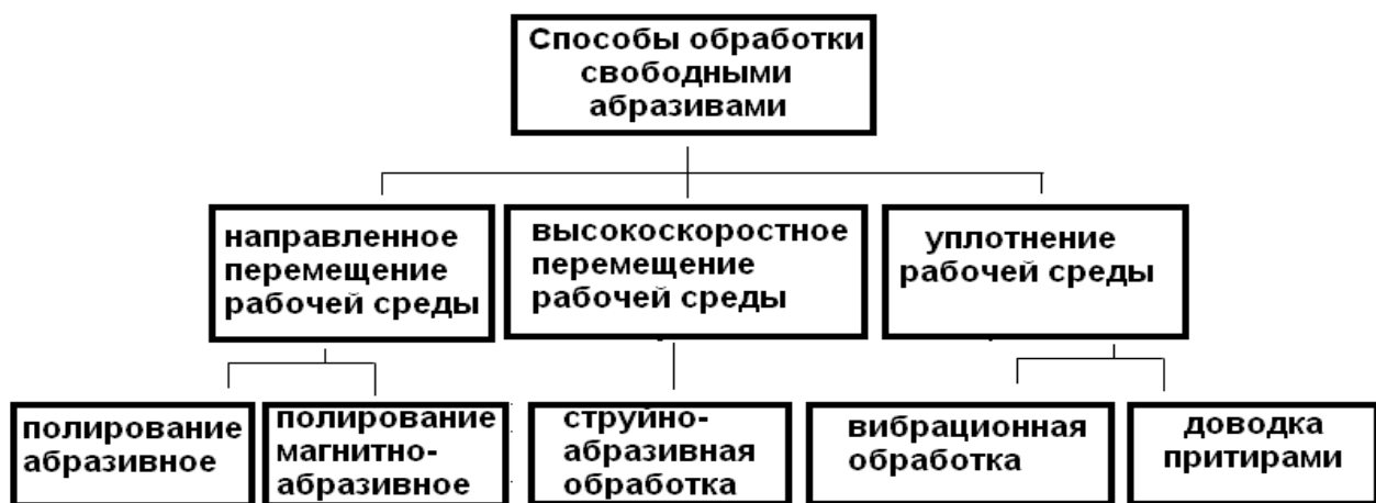
Рис. 7.12. Классификация способов обработки свободными абразивами по характеру воздействия абразивной частицы
