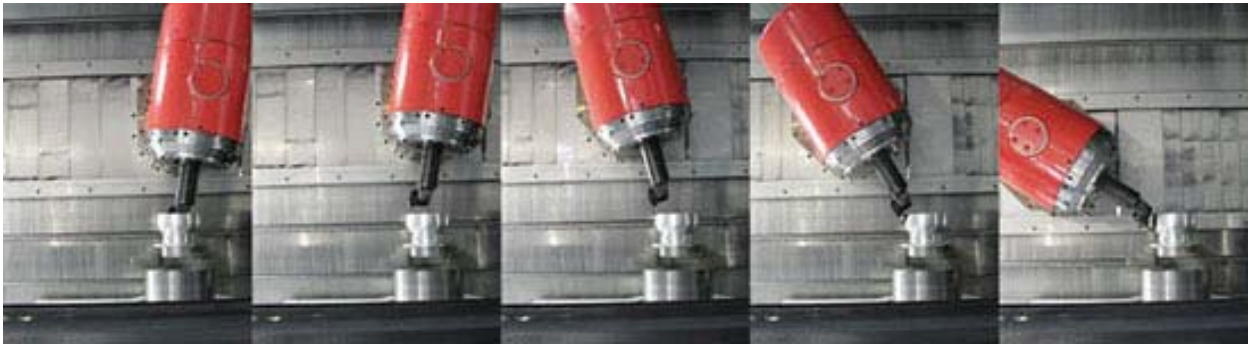
Рис. 3.57. Непрерывная финишная обработка с использованием оси В без смены инструмента
