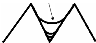
Рис. 7.14. След единичного зерна
