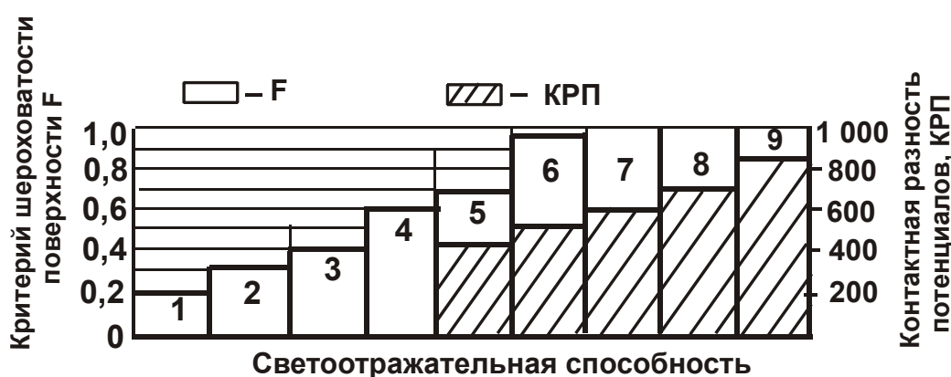
Рис. 7.10. Характер изменения светоотражательной способности и параметров поверхности от методов обработки деталей из сплава АМГ-6: 1 – прокат; 2 – гидроабразивная обработка; 3 – обработка металлической дробью; 4 – фрезерование твердосплавной фрезой; 5 – фрезерование фрезой из эльбора; 6 – точение твердосплавным резцом; 7 – алмазное полирование; 8 – выглаживание; 9 – алмазное точение
