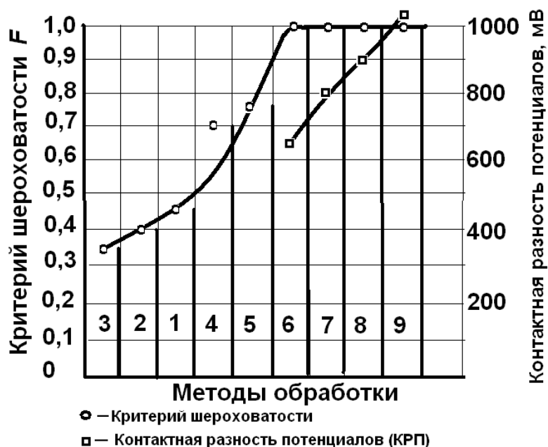
Рис. 7.9. Зависимость критерия шероховатости поверхности и КРП от методов обработки деталей из сплава АМг6:
