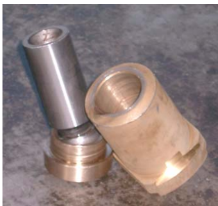
Рис. 4.2. Детали пары трения "поршень – цилиндр (втулка корпуса) " (а) и диск накладной (б)
