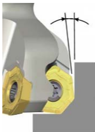
Рис. 3.8. Расположение пластины на фрезе под углом 45^{\circ}
