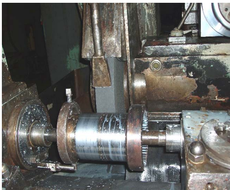
Рис. 4.4. Шлифование вала привода шахтного конвейера
