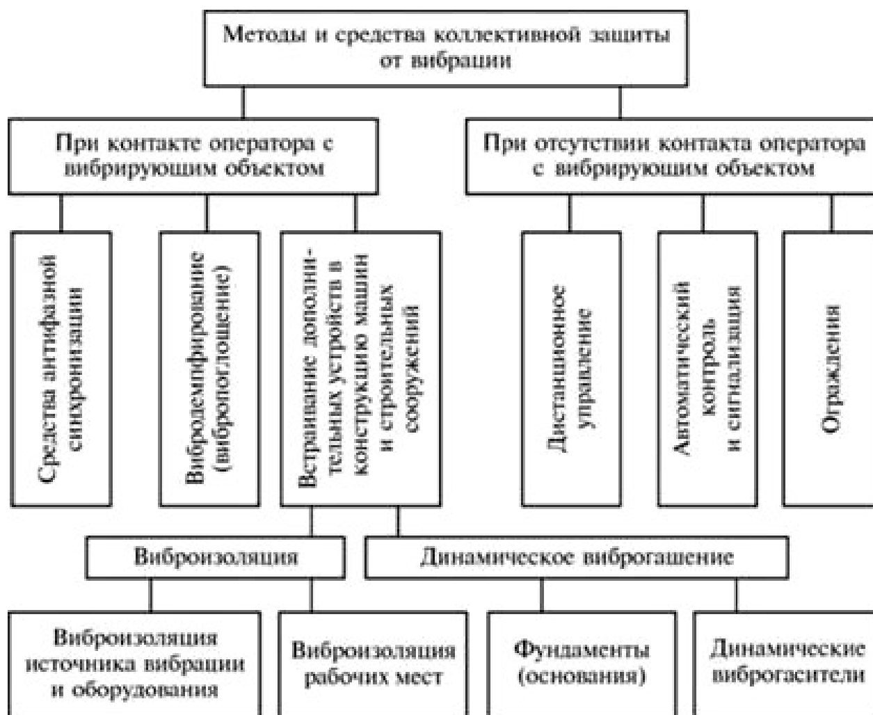
Рис. 11.2 – Классификация технических методов и средств защиты от вибраций
