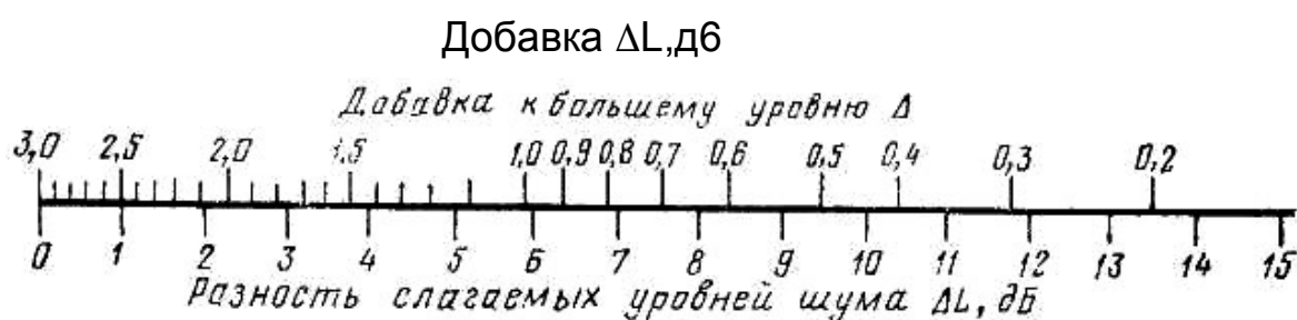
Рисунок 1.2 – Номограмма для сложения уровней шума от двух различных источников
