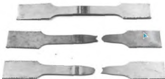
Рис. 2 – Образцы до и после разрушения на образца, мм; a_0 – толщина образца, мм; b_0 – ширина образца, мм. Замеры проводились по рискам на образцах до и после деформирования специальной лупой с точностью до 0,04 мм. Стандартные сварные образцы до и после разрушения представлены на рис. 2. Режимы термической обработки приведены в табл. 1.
