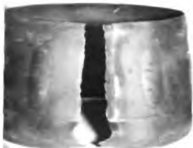
Рис. 1– Вид разрушения в околошовной зоне
