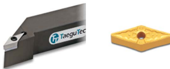
Рис. 2.38. Сборный токарный резец SVJNL 2525 M13 с углом в плане 93 градуса и со сменной многогранной пластиной TT8115
