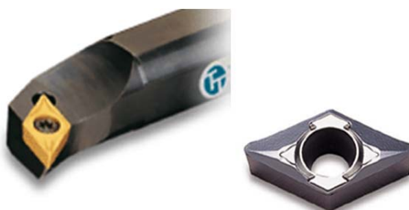
Рис. 2.41. Токарный резец S25T SDUCR 11 с углом в плане 93 градуса, оснащенный пластиной DCGT 11T304 FL из сплава K10
