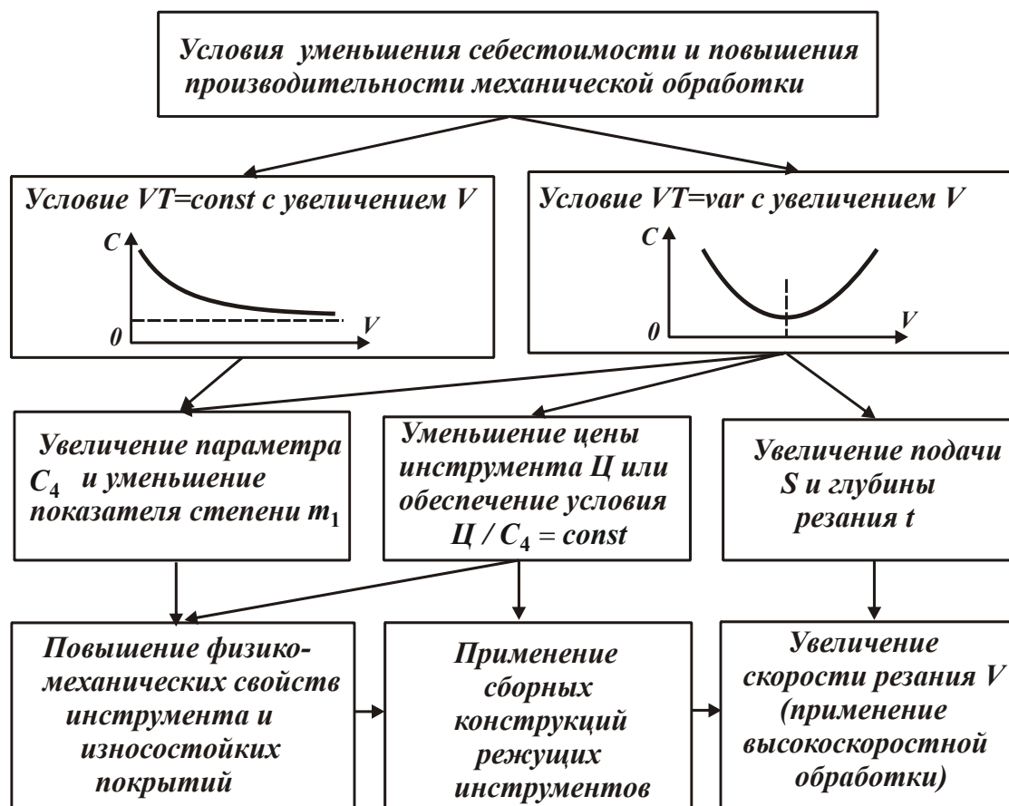
Рис. 2.11. Структурная схема условий уменьшения себестоимости и повышения производительности механической обработки
