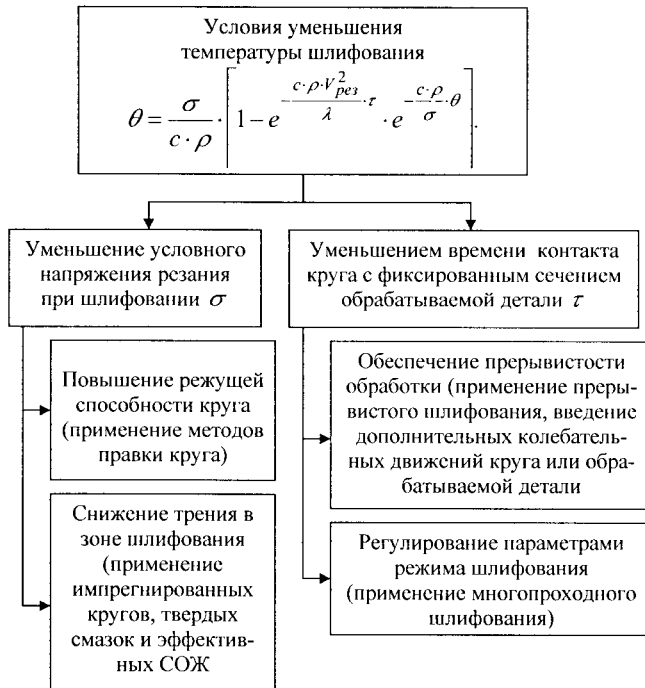
Рис. 3. Структурная схема условий уменьшения температуры шлифования.
