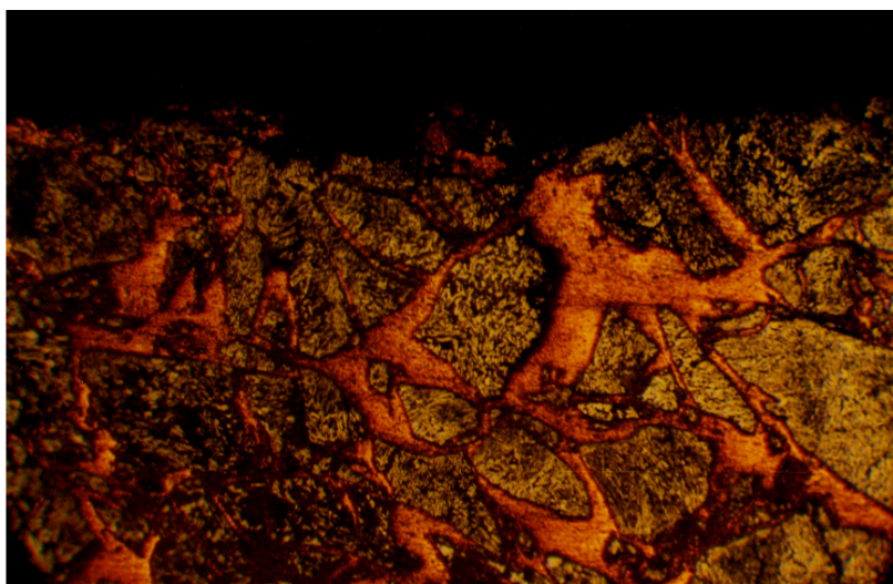
Рис. 2.15. Микроструктура композиции "твердый сплав "Релит" – медь"
