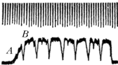
Рис. 5.31. Осцилограма зміни температури в зоні контакту шліфувального кола.
