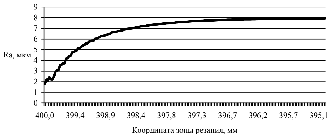
Рис. 2. Результаты моделирования среднего арифметического отклонения профиля.
