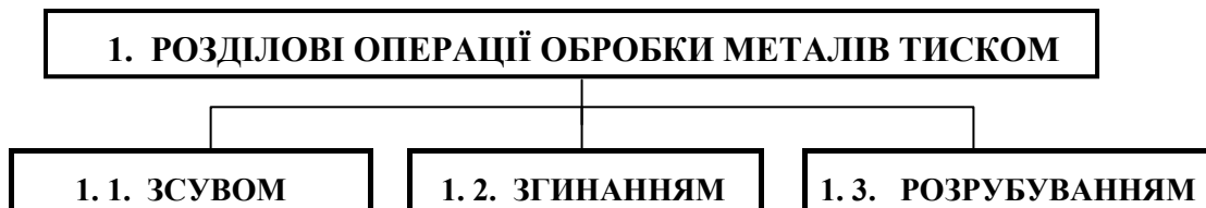
Рис. 4. Класифікація розділових операцій обробки металів тиском.
