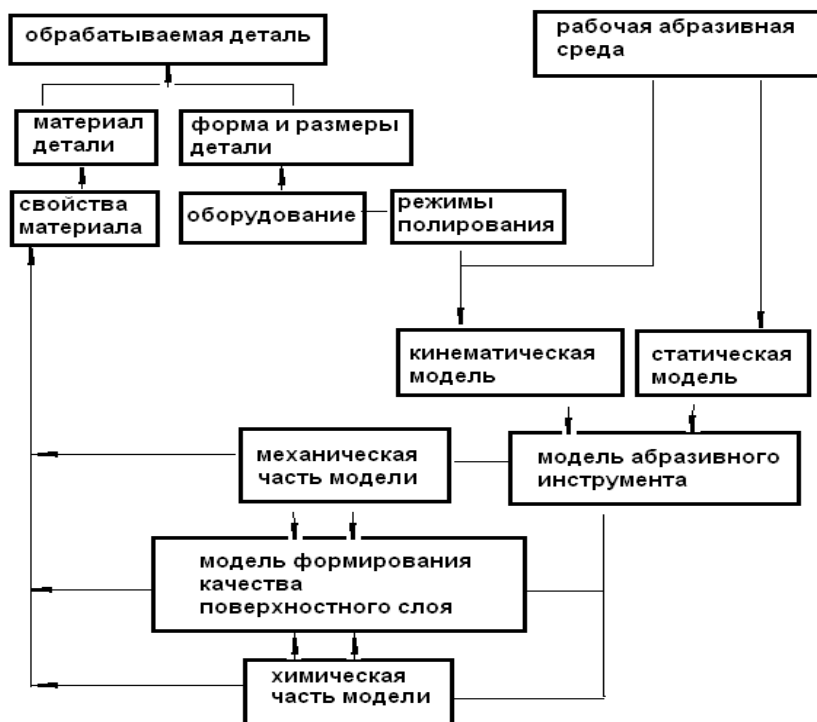
Рис. 1 – Формирование физико-химического состояния поверхностного слоя при обработке свободным абразивом
