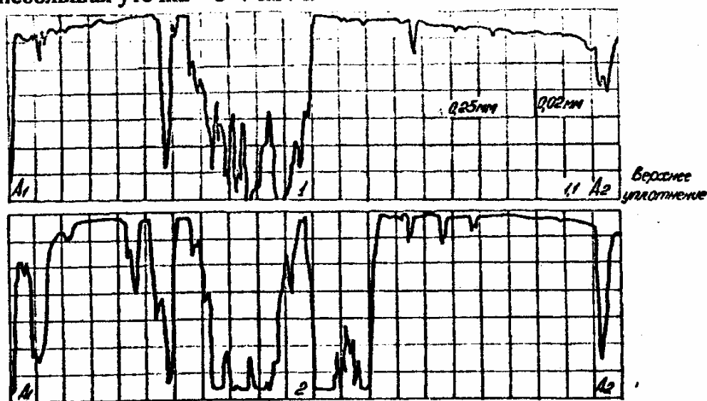
Рис. 8. Профилограммы уплотняющей поверхности релитовых торцовых уплотнений после испытания с маслом МС-20 ( \Delta P=12 МПа; n=280 об/мин; b=5 мм; общее время работы 552 ч): 1 – неврещающее кольцо; 2 – вращающееся кольцо.
