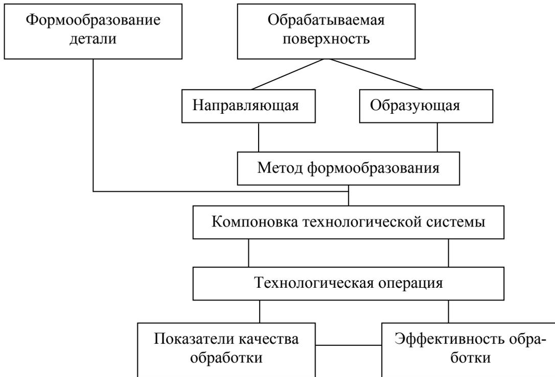
Рис. 1. Схема связи факторов формообразования и показателей качества и эффективности обработки деталей при формировании технологической операции.
