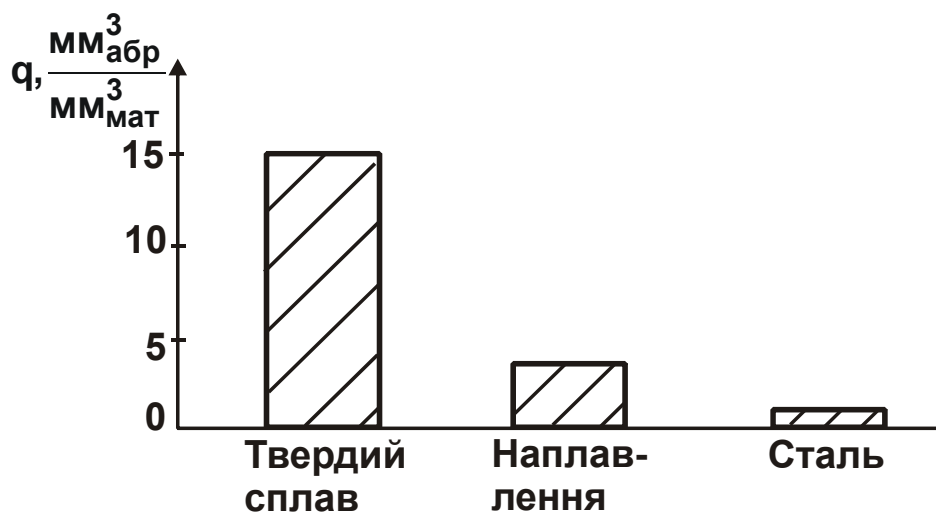
Рис. 5.11. Значення питомого зношування круга q для різних матеріалів
