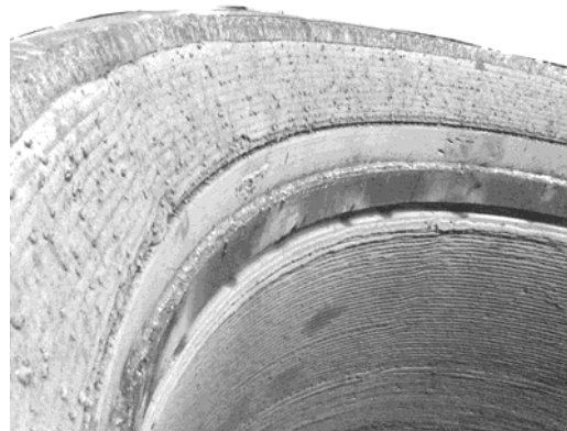
Рис. 1.4. Загальний вигляд малої чаші (а) і внутрішньої напавленої поверхні великої чаші (б) діаметром 5 400 мм
