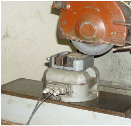
Рис. 1.45. Плоскошліфувальний верстат моделі 3Г71 і динамометр УДМ-600 (а) та десятиканальний тензопідсилювач моделі "Топаз-3.1" (б)
