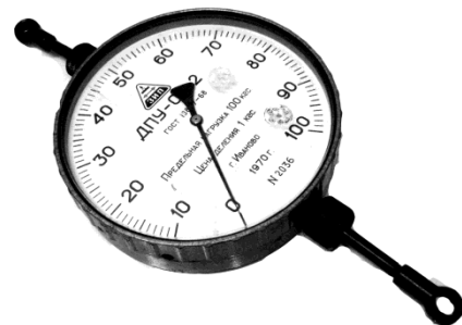
Рис. 1.44. Індикатори годинникового типу ІЧ-10 (а) і ІЧ-08 (б) та динамометр розтягання із ціною розподілу шкали 10 Н (в)
