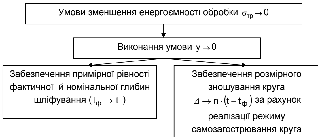
Рис. 4.12. Структурна схема реалізації умови \sigma_{тр} \rightarrow 0
