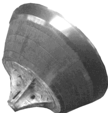
Рис. 1.5. Загальний вигляд обробленої шліфуванням напавленої поверхні великого конуса діаметром 5 000 мм (а) і циліндричної поверхні прийомної вирви (б)
