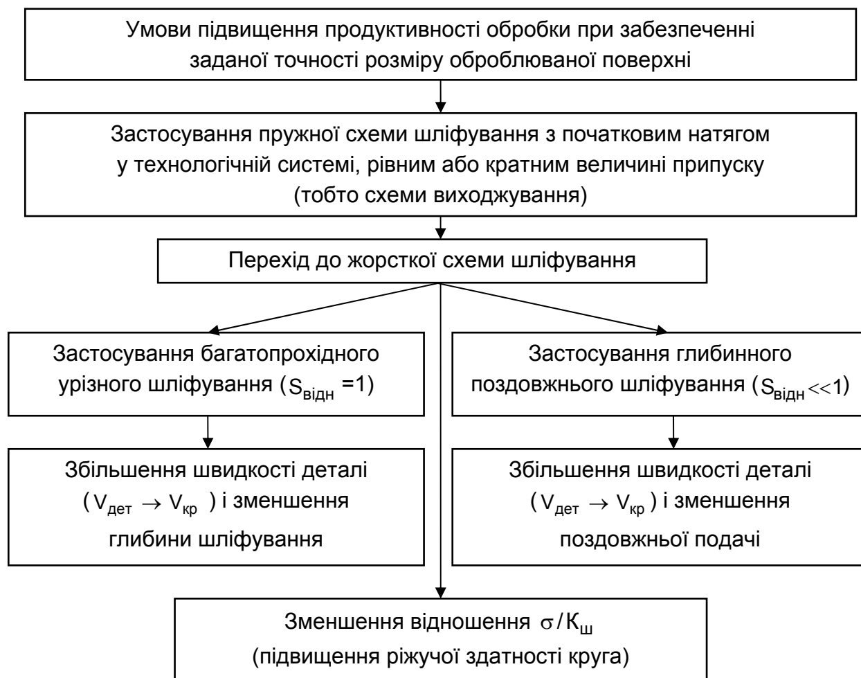
Рис. 3.16. Структурна схема умов підвищення продуктивності обробки при забезпеченні заданої точності оброблюваної поверхні при круглому зовнішньому шліфуванні
