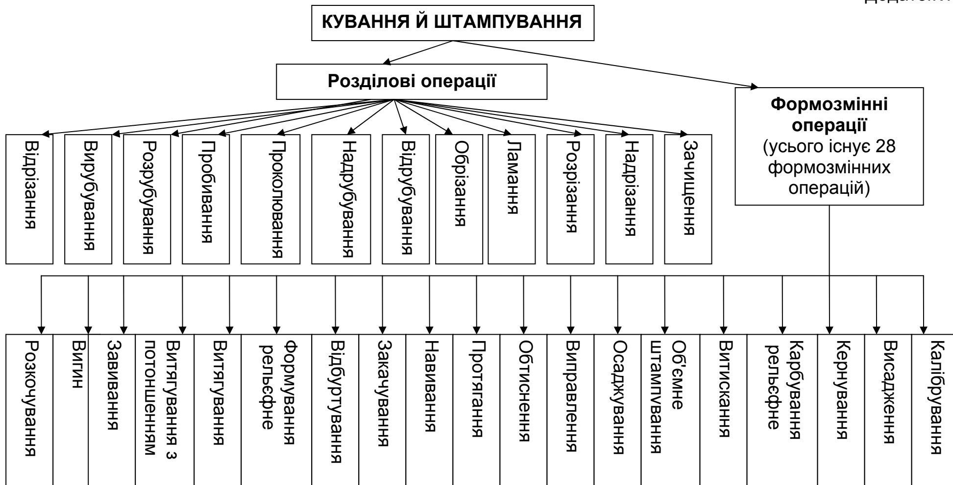
Рис. Ж.1. Класифікація основних операцій, які застосовуються в процесі кування й штампування
