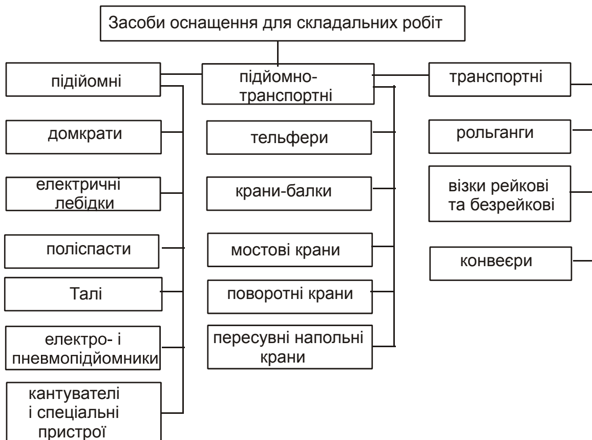
Рис. 7.144. Підйомно-транспортні засоби для складальних операцій
