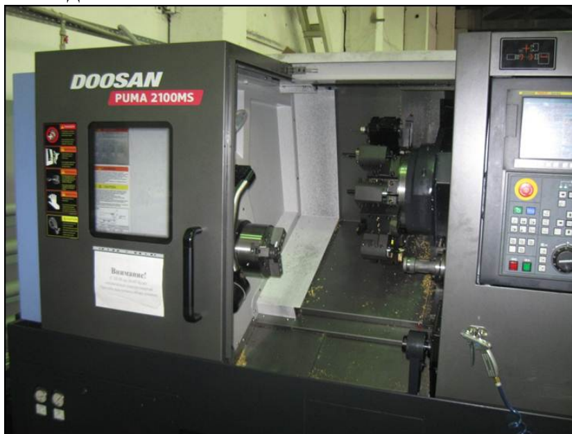
Рис. 2. Высокопроизводительный двухшпиндельный токарный обрабатывающий центр PUMA 2100MS с приводным фрезерным инструментом (ось С) и контр-шпинделем (“DOOSAN”).
