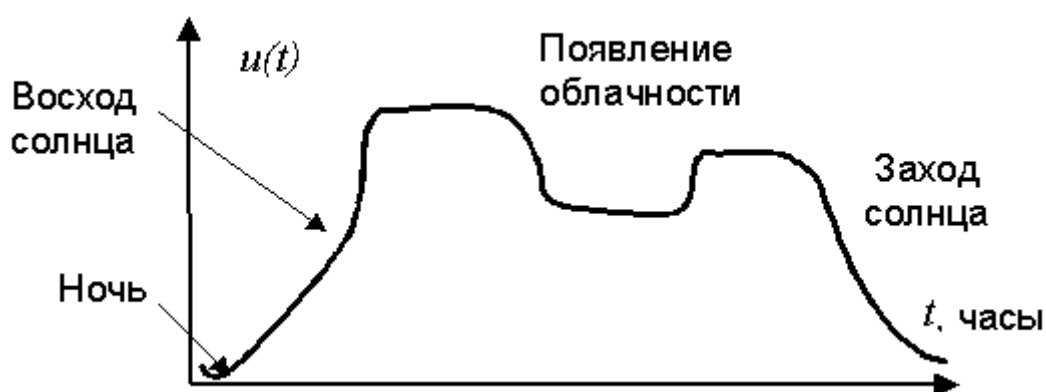
Рис. 1.20. Сигнал на выходе датчика освещенности в течение дневного времени суток: величина напряжения очень медленно изменяется во времени
