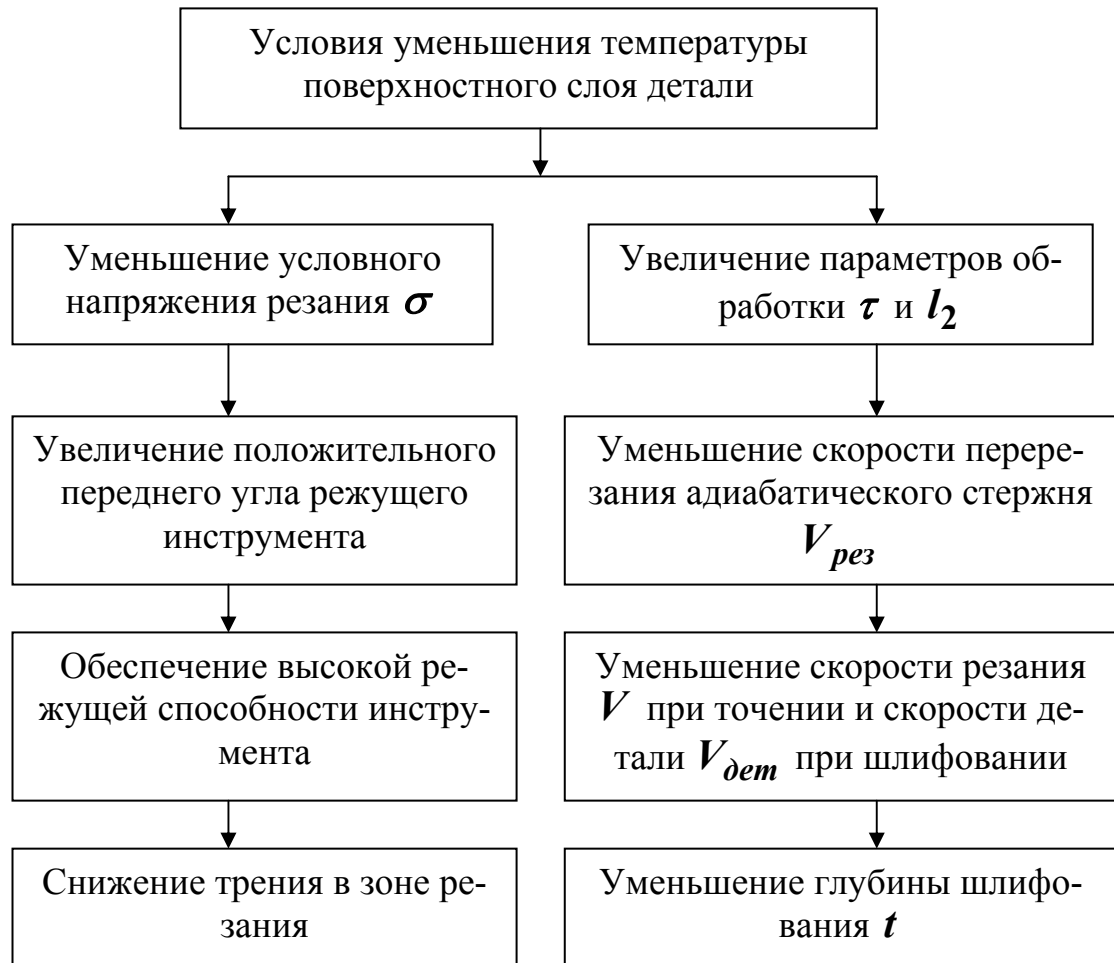
Рис. 3.9. Структурная схема условий уменьшения температуры поверхностного слоя детали при ее механической обработке.
