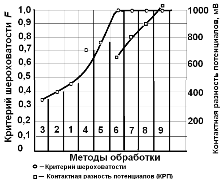
Рис. 1. Зависимость критерия шероховатости поверхности и КРП от методов обработки деталей из сплава АМгб: 1 – прокат; 2 – обработка металлической дробью; 3 – гидроабразивная обработка; 4 – фрезерование твердосплавной фрезой; 5 – фрезерование фрезой из эльбора; 6 – точение твердосплавным резцом; 7 – полирование алмазное; 8 – выглаживание; 9 – микроточение алмазным резцом
