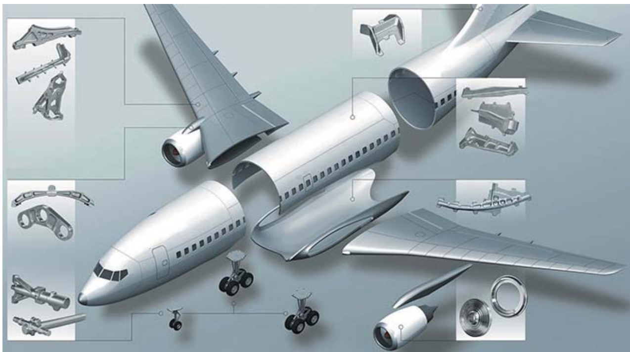
Рис. 1. Детали и узлы самолета, подвергаемые механической обработке
