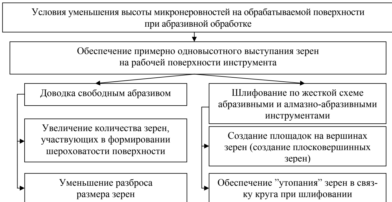
Рисунок 1 – Структурная схема условий уменьшения высоты микронеровностей на обрабатываемой поверхности при абразивной обработке
