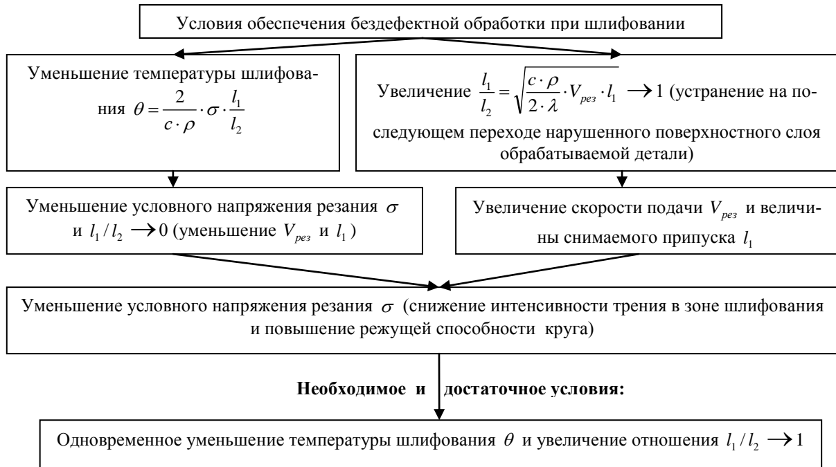
Рис. 3. Структурная схема условий обеспечения бездефектной обработки при шлифовании.
