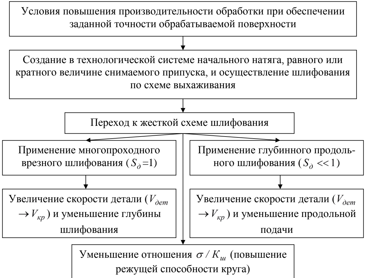
Рис. 6. Структурная схема условий повышения производительности при обеспечении заданной точности обработки при круглом наружном шлифовании.
