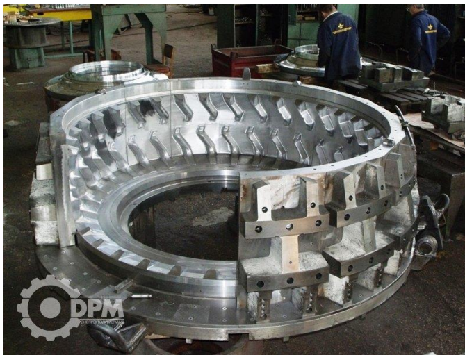
Рис. 13. Сектор (елемент) прес-форми для шини діаметром 2 200 мм у зборі (а) і його обробка на верстаті (б)
