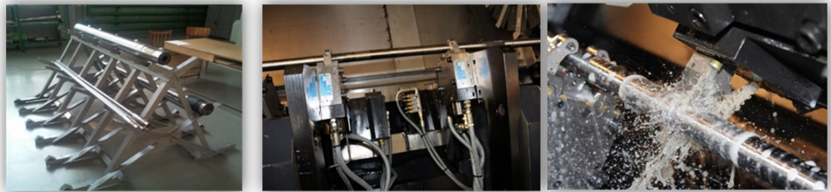
Рис. 2 Загальний вигляд оброблюваних валів та їх обробка твёрдосплавним інструментом на токарному верстаті
