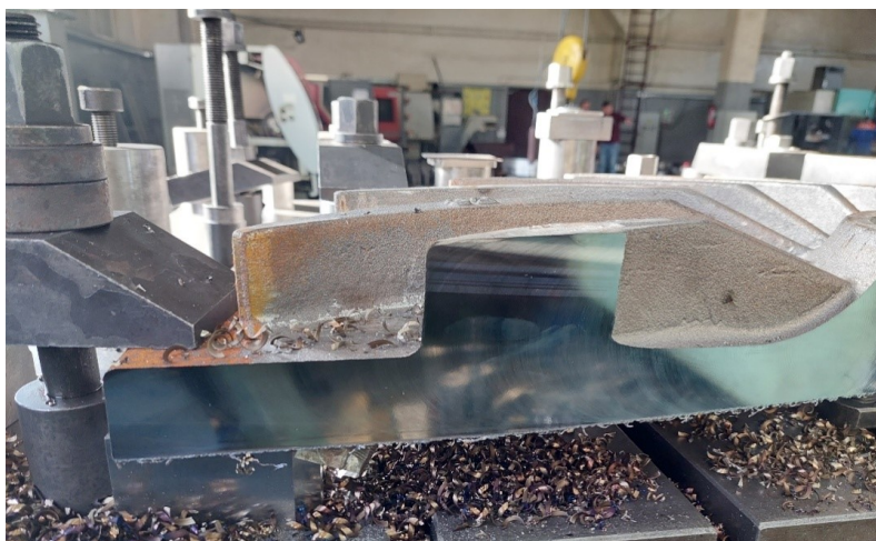
Рис. 3 Обробка великогабаритної деталі «Апарат напрямний»
