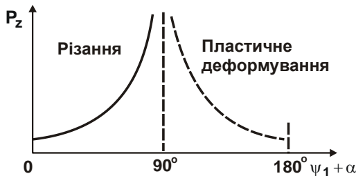
Рисунок 1.4 – Загальний вигляд залежності тангенціальної складової сили різання P_z від кута \psi_1 + \alpha
