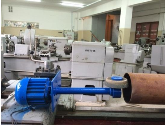
Рисунок 4.23 – Схема абразивної обробки отвору у циліндрі
