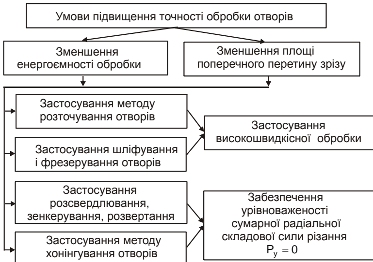
Рисунок 5.12 – Структурна схема умов підвищення точності обробки отворів із нерівномірним припуском
