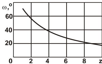
Рисунок 5.25 – Залежність кута нахилу зубів розвертки \omega від їх кількості z
