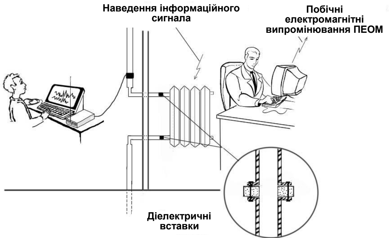
Рис. 2.7. Установка спеціальних діелектричних вставок
