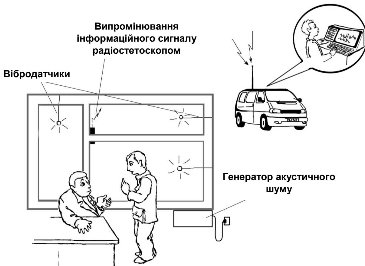
Рис. 2.13. Створення віброакустичних завад радіосигналу
