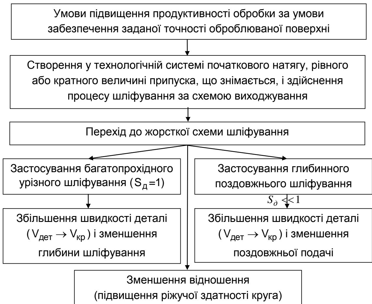
Рисунок 5.18 – Структурна схема умов підвищення продуктивності із забезпеченням заданої точності обробки під час зовнішнього круглого шліфування
