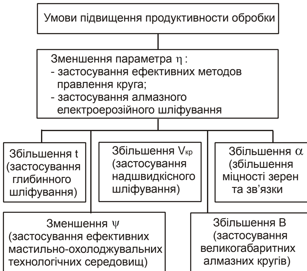
Рисунок 4.12 – Структурна схема умов підвищення продуктивності обробки
