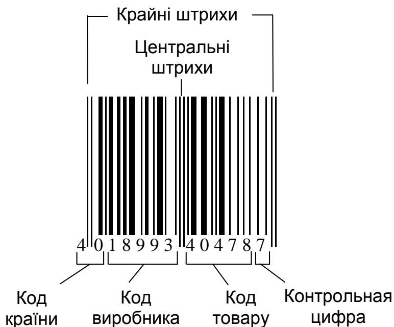
Рис. 1. Приклад графічного та числового відображення штрихового коду EAN-13
