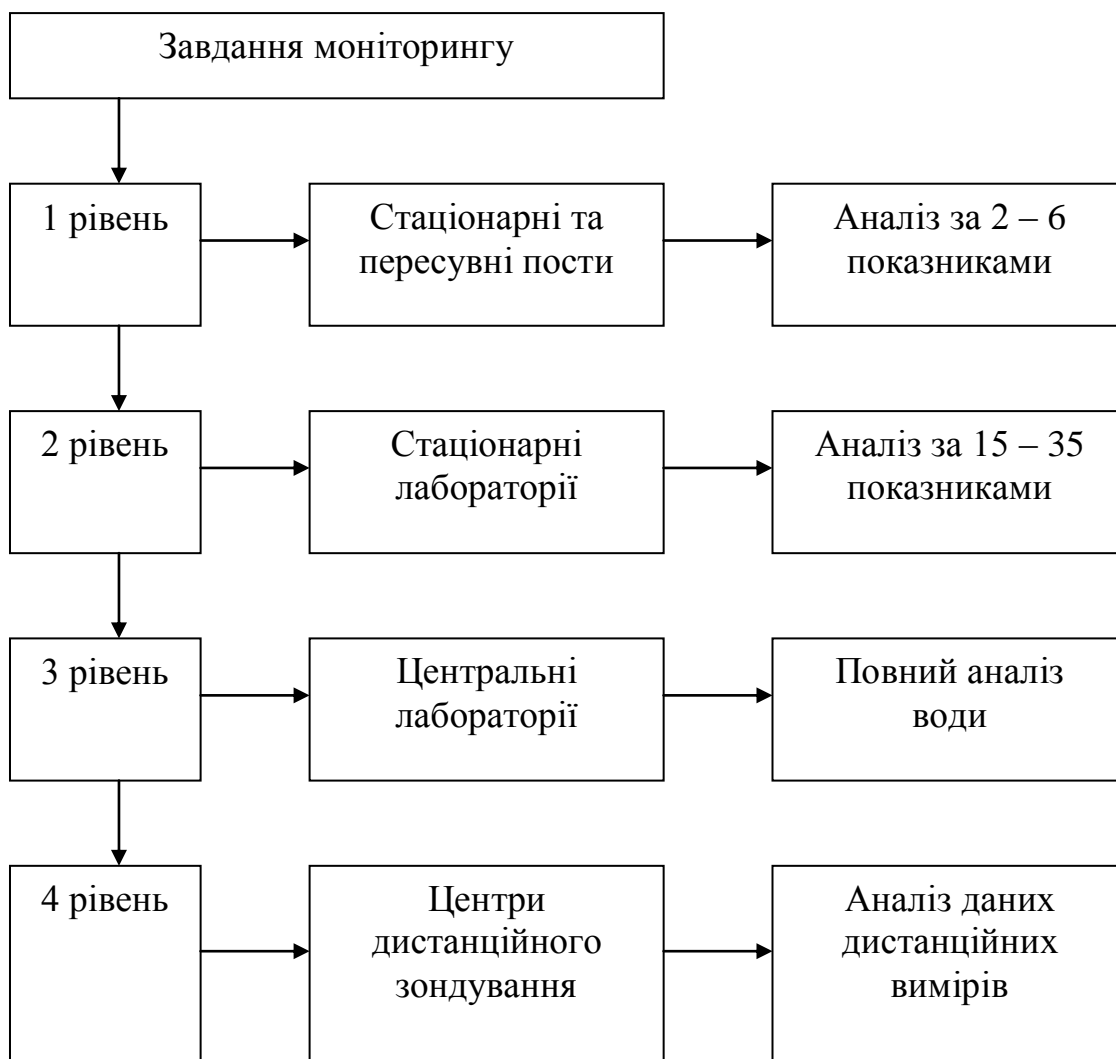
Рис. 1. Схема рівнів аналітичного контролю регіональної системи екологічного моніторингу в межах басейну
