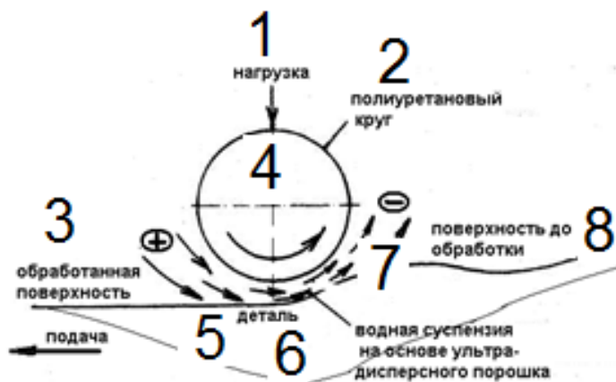
Рис. 6. Схема полирования суспензией на основе ультрадисперсного порошка.
