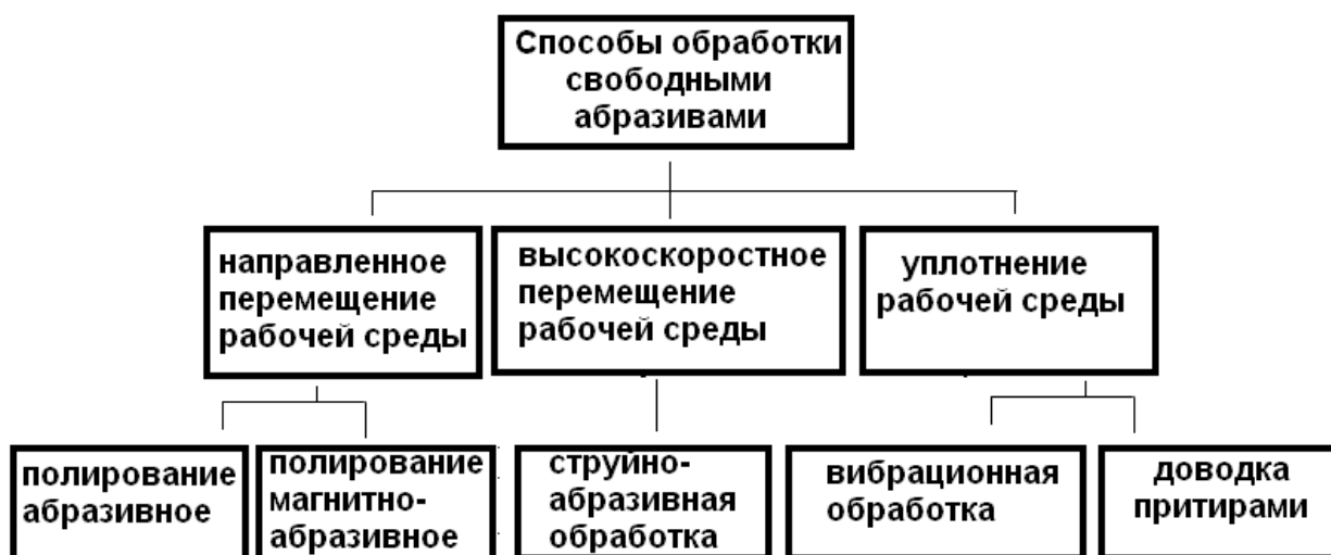
Рис.1. Классификация способов обработки свободными абразивами по характеру воздействия абразивной частицы.
