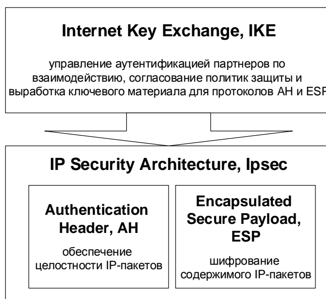
Рис. 16.9. Структурная схема протокола IPsec
