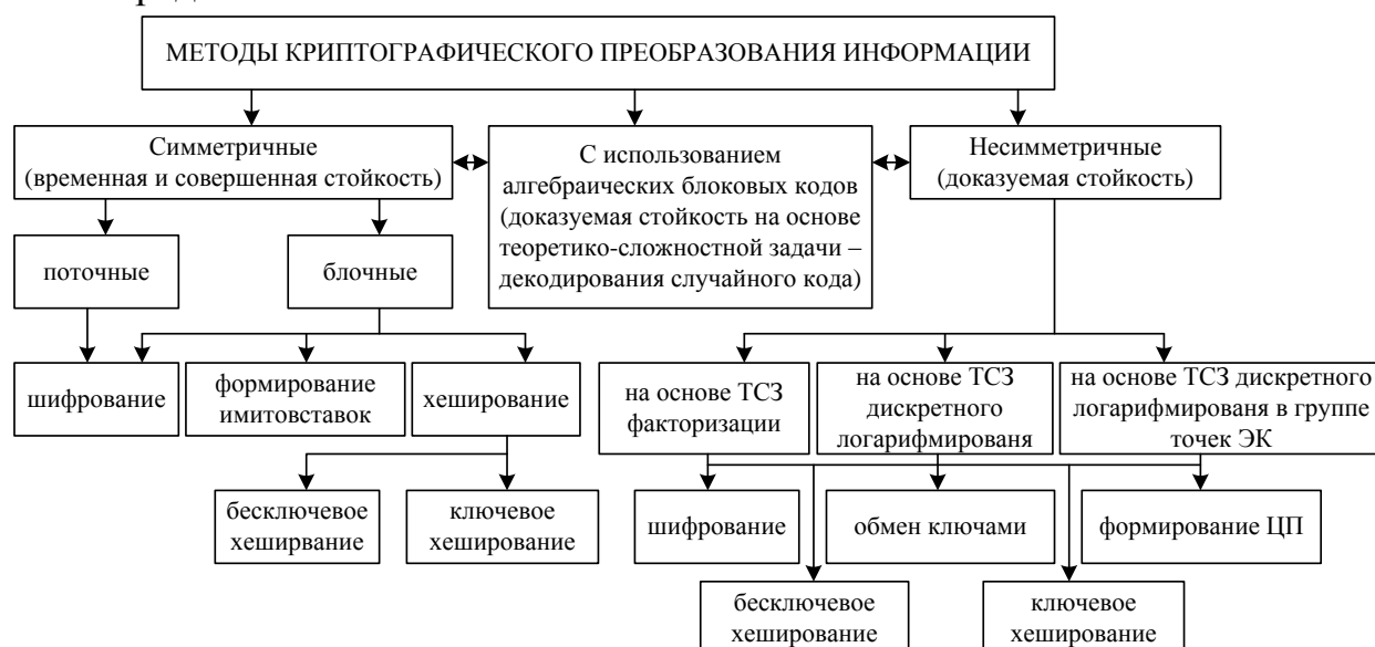
Рис. 16.8. Общая классификация криптографических методов защиты
